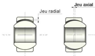
Les rotules et embouts à rotules possèdent un jeu initial ou un couple de glissement qui est propre au type et à la grandeur.
