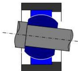
Pour des rotules autolubrifiées, il est impératif que l'axe soit monté à sec. On utilisera un ajustement m6 pour les séries standard et inox avec contact de frottement acier/acier, et un ajustement k6 pour toutes les autres références.
