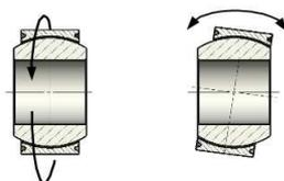
Le couple de la rotule peut être mesuré par rapport à deux axes perpendiculaires. On distinguera :
