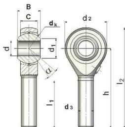
Le diamètre de tête  $d_2$  est dimensionné sur la valeur inférieure de la norme, ce qui confère à nos embouts à rotule un encombrement et un poids minimal, assurant ainsi une interchangeabilité totale avec tout autre embout à rotule répondant à la norme.
