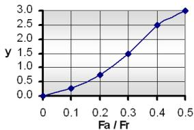
Coefficient de charge axiale **y** et charge dynamique équivalente :
